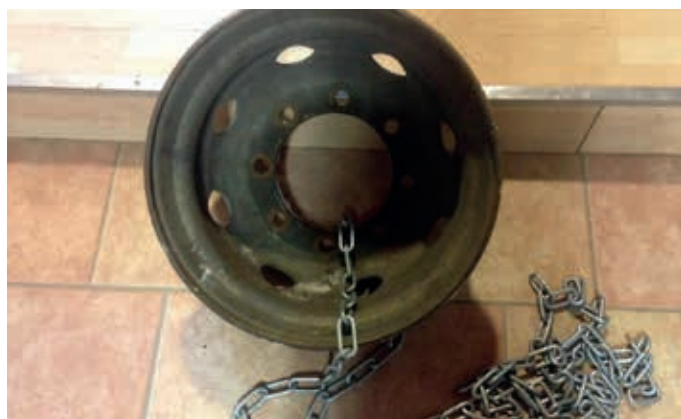
Till förankring finns skålade lastbilsfälgar med kätting. Fungerar bra om botten består av lera, dy eller sand.
